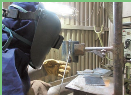
Soldagem eletrodo revestido
