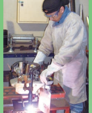
プラズマ切断
